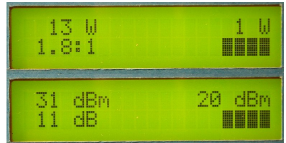
Figure 4: Affichage en W ou en dBm (pas de la même puissance !).
